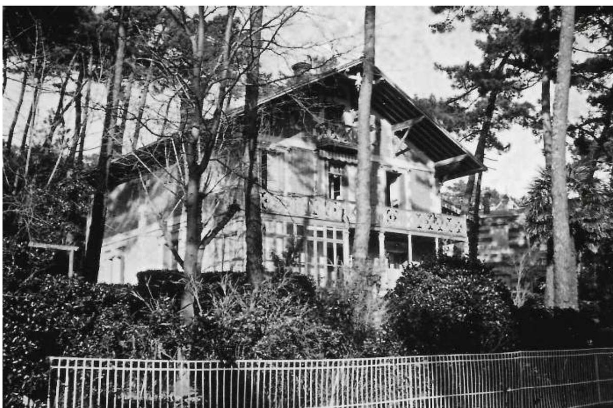
La villa comprend un rez-de-chaussée (moellon apparent), un étage carré et un étage de comble (brique). Le toit à longs pans (pignon couvert) est couvert de tuiles mécaniques. Un balcon (garde-corps en bois) se situe à l'étage des élévations nord et sud.
